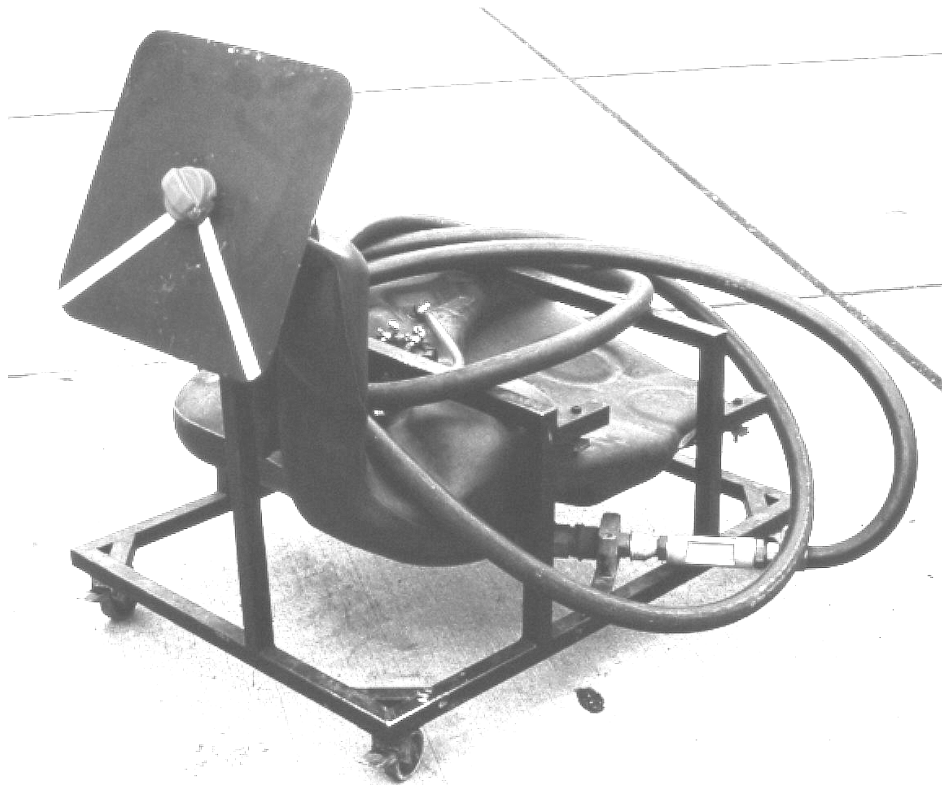
Bild 1: Prüftank in einer Halterung und mit Andruckplatte am Einfüllstutzen.
